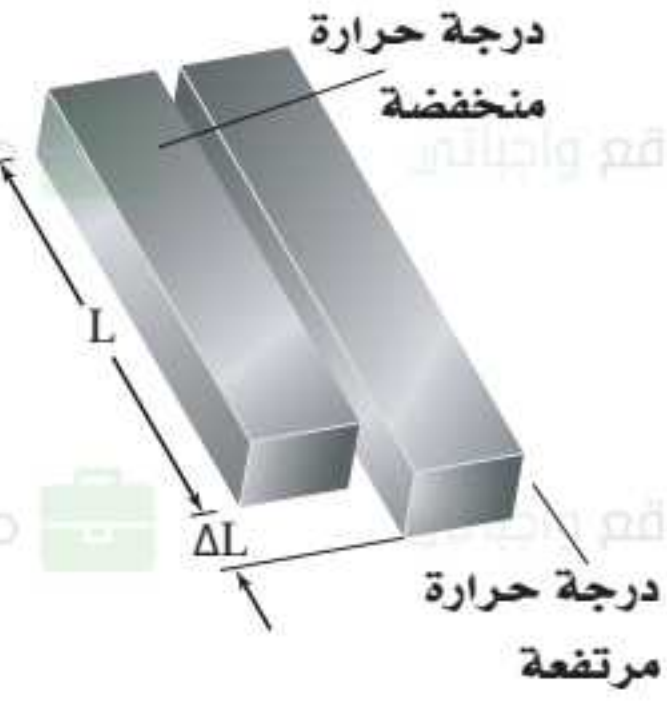
الشكل 1-21 يتناسب التغير في طول المادة طردياً مع الطول الأصلي والتغير في درجة الحرارة.
