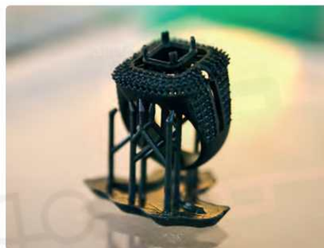
شكل 3.18: خاتم بوليمر ضوئي مطبوع باستخدام طباعة ثلاثية الأبعاد
