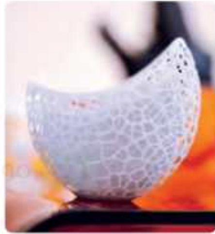
شكل 3.2: نموذج مطبوع بالبوليمرات الضوئية بواسطة طابعة ثلاثية الأبعاد
