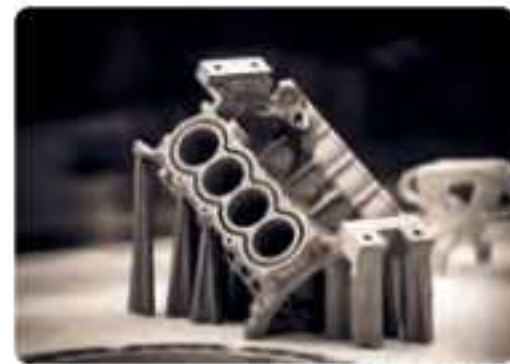
شكل 3.4: مجسّم مطبوع بواسطة آلة تليد بالليزر
