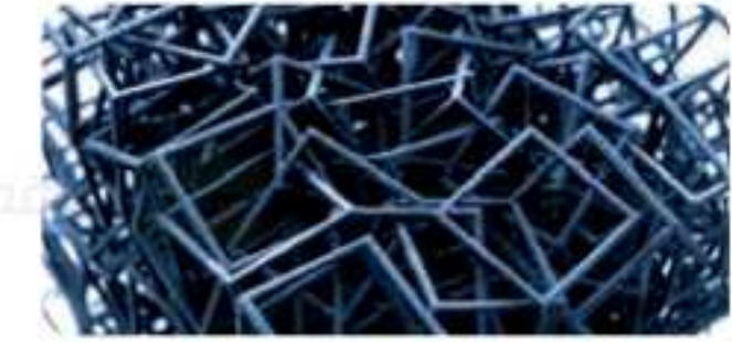
شكل 3.7: نموذج مطبوع باستخدام عملية النفث المادي
